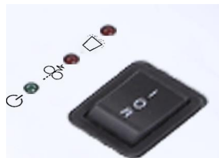
Kontrolky zapnutí, plného koše a zaseknutého papíru
